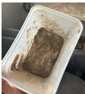
Figura 5: Concreto convencional seco após 1 semana
