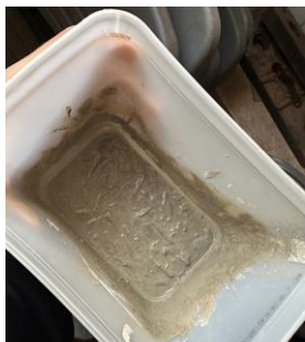
Figura 1: Concreto com bagaço de cana picado recém feita a mistura
