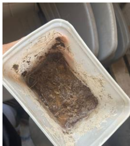
Figura 3: Concreto com fibra do coco e pó da fibra do coco recém feita a mistura
