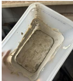
Figura 4: Concreto com o bagaço de cana picado seco após 1 semana
