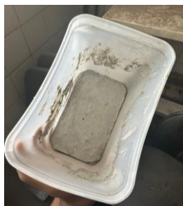
Figura 6: concreto com fibra de coco e pó da fibra de coco seco após 1 semana
